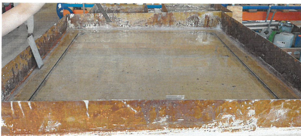
Obrázek 3: Zkouška vodotěsnosti – ACO Access Cover PAVING H80 sestava 600x600 D400
