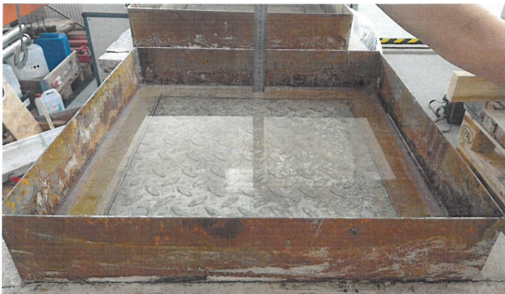
Obrázek 1: Zkouška vodotěsnosti - ACO Access Cover SOLID sestava 300x300x60 B125
