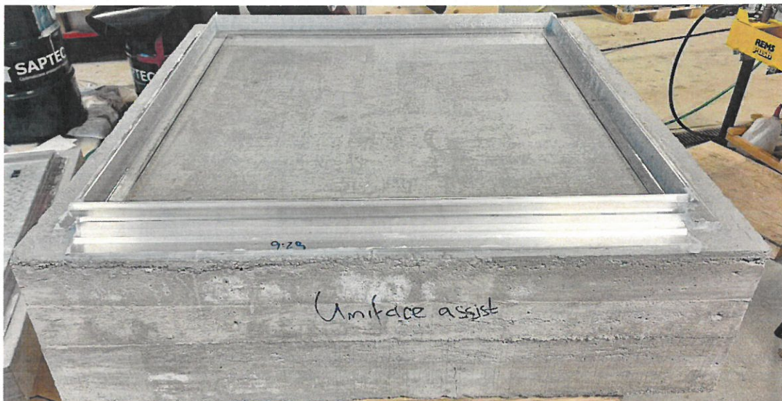
Obrázek 1: Zkouška vodotěsnosti - ACO Access Cover Uniface ASSIST 600x600x70, M125, 1.0037
